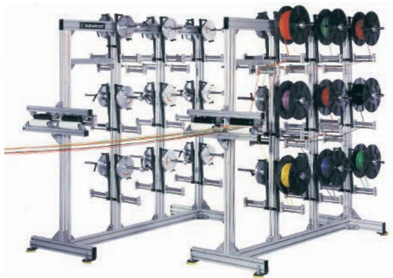
SPULROLLY – układy jednoczesnego podawania grupy przewodów, celem stworzenia wspólnej wiązki kablowej. Konstrukcja oparta na aluminiowych profilach ramowych – tym samym możliwa jest ich szybka modyfikacja, pozwalająca dostosować zestaw do potrzeb konkretnego projektu.
